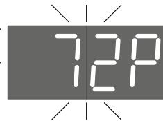
Um die Grenztemperatur einzustellen, drücken Sie eine beliebige Taste. Der eingestellte Temperaturwert im Raum «C» erscheint und beginnt zu blinken. Bis der Wert blinks, drücken Sie und halten Sie beide Tasten gleichzeitig mindestens 2 Sekunden. Nach dem Signalton wird der eingestellte Wert der Grenztemperatur der Heizoberfläche «P» angezeigt und startet zu blinken. Stellen Sie den neuen Wert und warten Sie 6 Sekunden, um die Installationen zu beenden.
