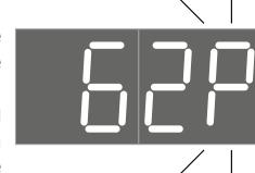
**Achtung!** Wenn die Oberflächentemperatur des Heizgerätes ständig angezeigt wird, dann ist der Fernbedienungssensor nicht angeschlossen oder beschädigt. Dabei, unabhängig von der Raumtemperatur, wird die Heizeroberfläche kontinuierlich zum eingestellten Wert „P“ (s. unten) erwärmt.
