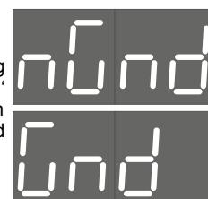
✗ Um die Funktion der Heizungsbeendigung bei der Abwesenheit der Erdung anzuschalten und auszuschalten, muß man im Zeitpunkt der Anzeige 'Grnd' (s. oben) beide Tasten drücken und gedrückt halten und dann spätestens nach 1,5 Sekunden den Stecker entfernen und wieder in die Buchse einsetzen und sobald die entsprechende Anzeige (s. rechts) erscheint, die Tasten lassen.
