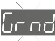
✓ Thermocontroller des Heizgerätes kontrolliert beim Anschalten ins Netz, sowie während der gesamten Operation das Vorhandensein der Erdung und warnt bei der Abwesenheit (s. links), wonach, in Abhängigkeit von der vorgegebenen Funktion (s. unten), deaktiviert die Heizung, wartend auf die Erde, oder, nach der Warnung, genehmigt die Arbeit ohne Erdung.
