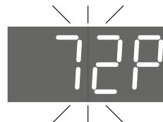
Om de maximale temperatuur in te stellen, druk op een willekeurige knop. De ingestelde kamer temperatuur 'C' verschijnt en begint te knipperen. Terwijl deze waarde knippert, druk beide knoppen in en houdt deze ten minste 2 seconden ingedrukt. Na een toon signaal zal de display de ingestelde maximale oppervlakte temperatuur 'P' weergeven en deze laten knipperen. Stel de gewenste waarde en, en wacht 6 seconde om de instelling op te slaan en uit het menu te gaan
