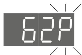
**Attentie!** Indien de oppervlakte temperatuur constant weergegeven wordt, betekent dit dat de externe thermometer niet aangesloten of beschadigd is. Tegelijkertijd zal de oppervlakte temperatuur van de verwarming constant op de ingestelde waarde 'P' (zie beneden) gehouden worden, ongeacht van de kamer temperatuur.
