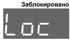
● **Knoppen ontgrendelen.** Steek de stekker in het stopcontact terwijl u de '-' knop ingedrukt houdt, en laat niet los totdat u de overeenkomstige bevestiging van de verwarming krijgt
