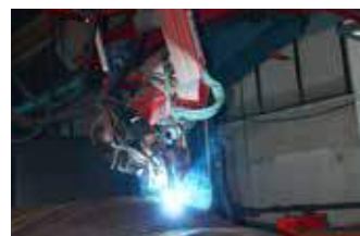
3. Robotlassen voor grote speciale vaten
